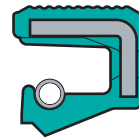
Versión BAX7 (A DIN 3760) Recubrimiento exterior rayado.
