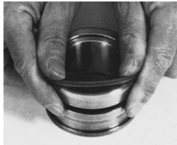
FIGURA 20. Posicionamiento de la junta de estanqueidad de poliuretano.
