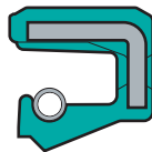
Versión BA (A DIN 3760) Recubrimiento exterior liso.
