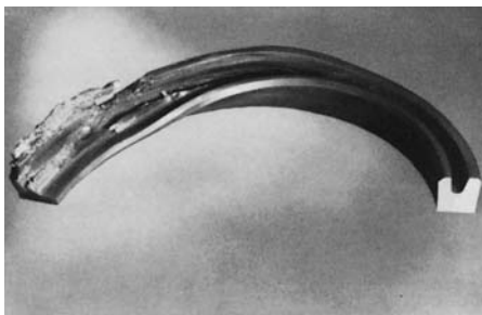
FIGURA 7. Junta destruida por la formación de presiones hidrodinámicas
