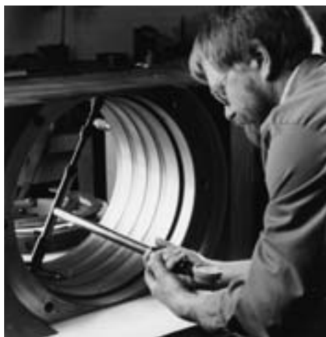
Medición del agujero del soporte con un micrómetro de interiores
