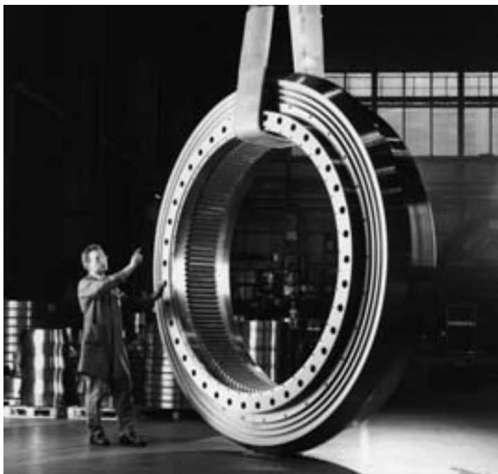
Rodamiento axial-radial de rodillos cilíndricos con corona dentada integrada
