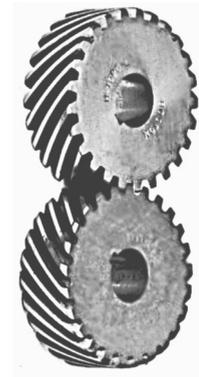
(a) Par de engranes acoplados en orientaciones opuestas, con ejes paralelos
