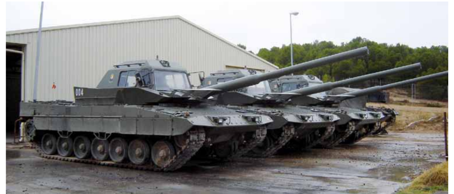
EL CARRO ESCUELA, CONSTITUIDO POR UN CHASIS LEOPARDO CON UNA TORRE SIMULADA Y ACRISTALADA.
