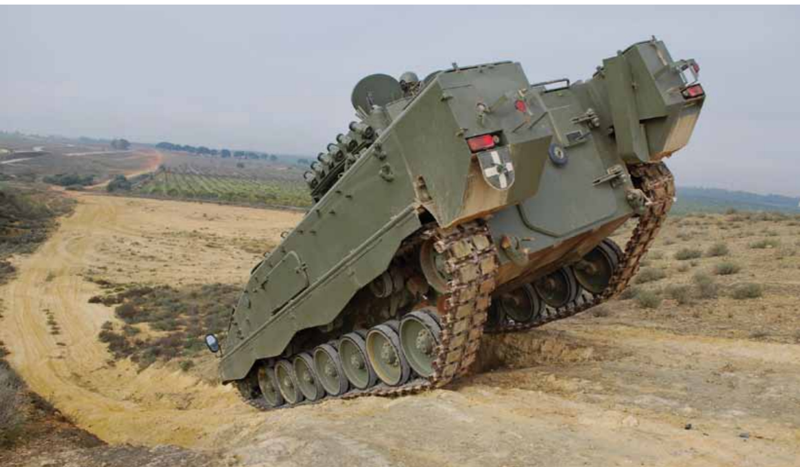
PROTOTIPO DE LA 2ª FASE REALIZANDO PRUEBAS DE MOVILIDAD.
