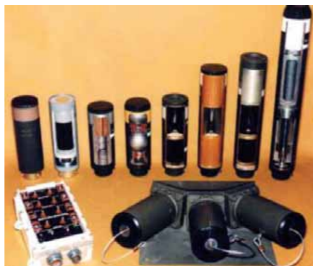
LANZADORES, CAJA DE MANDO Y ARTIFICIOS DEL SISTEMA GALIX.
