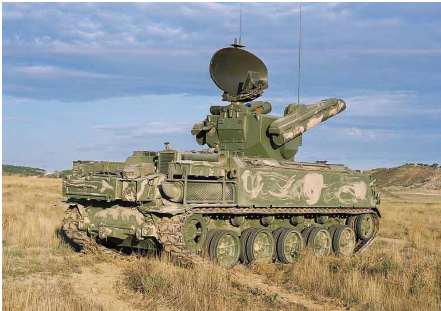
LAS ÚNICAS PIEZAS ATP ANTIAÉREAS DISPONIBLES SON LAS ROLAND INSTALADAS SOBRE CHASIS AMX-30.
