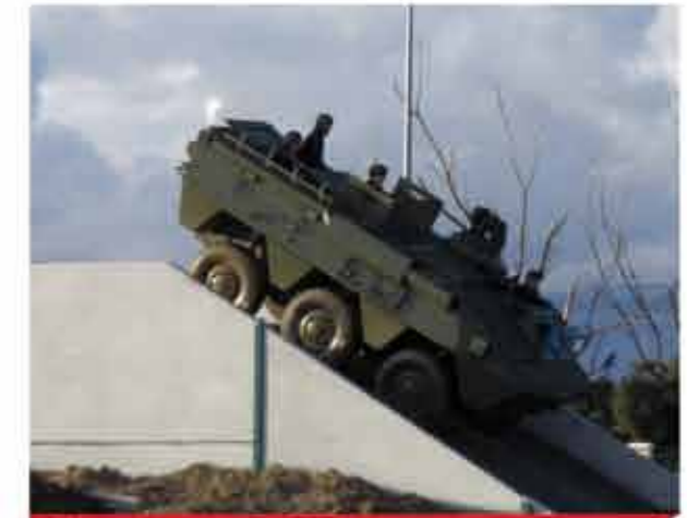
Pista de pruebas de EXPAL: Prueba de pendiente del 60%
