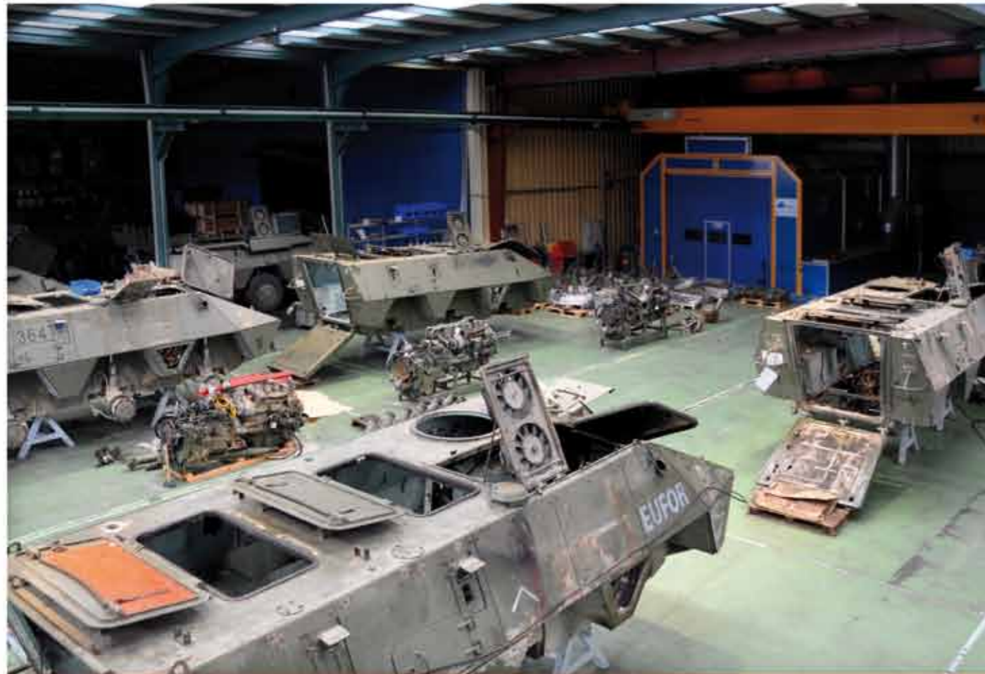
Programa de mantenimiento de 4º escalón de BMR y modernización a modelo M1A en las instalaciones de mantenimiento de vehículos de EXPAL en Naval Moral de la Mata
