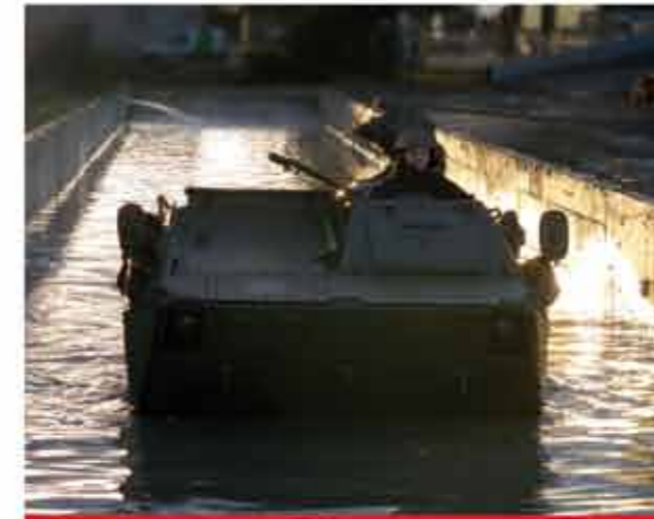
Pista de pruebas de EXPAL: Prueba de vadeo y flotación
