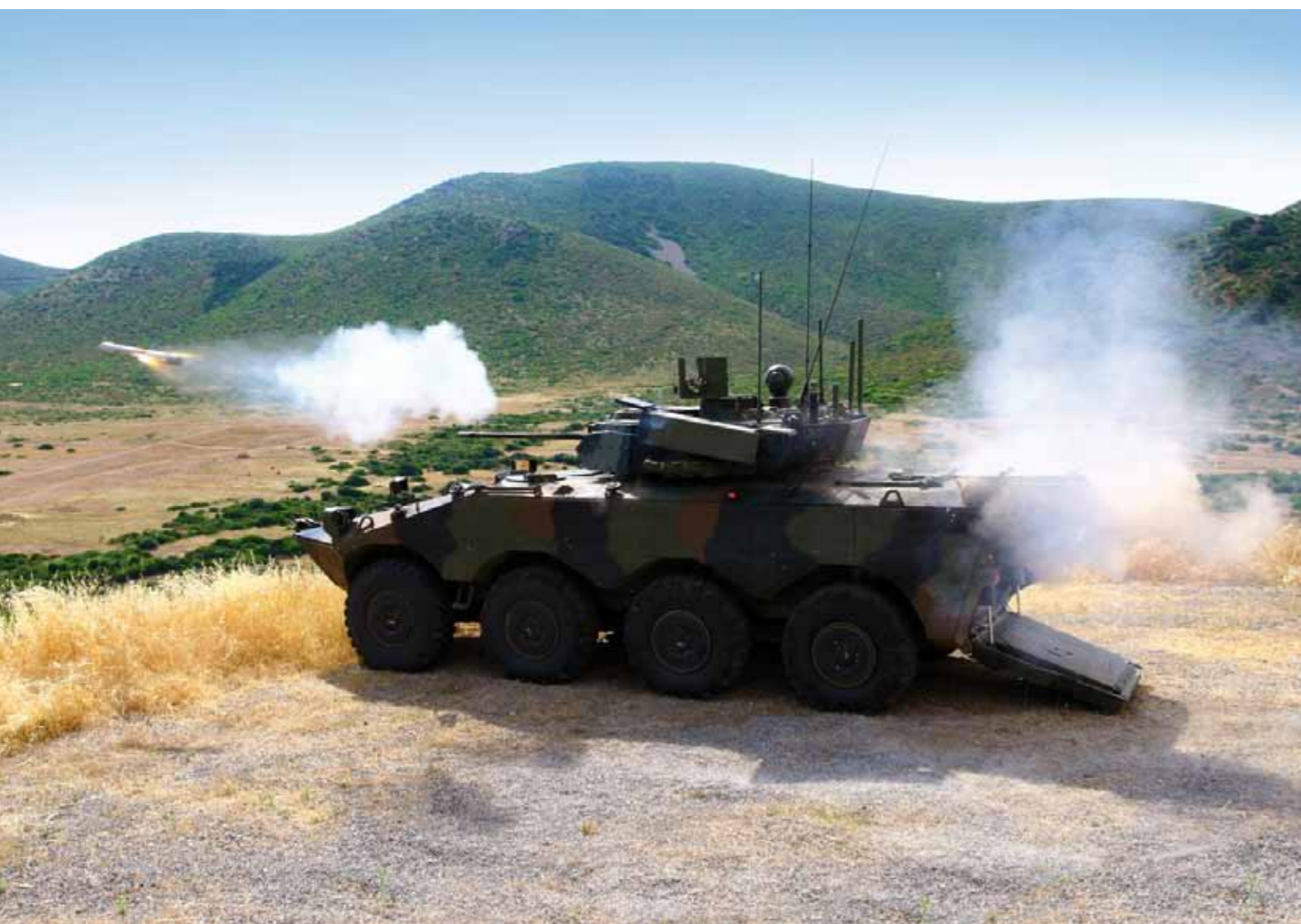
PRUEBA DE UNA TORRE DOTADA DE CAÑÓN DE 25 MM Y LANZADOR SPYKE.
