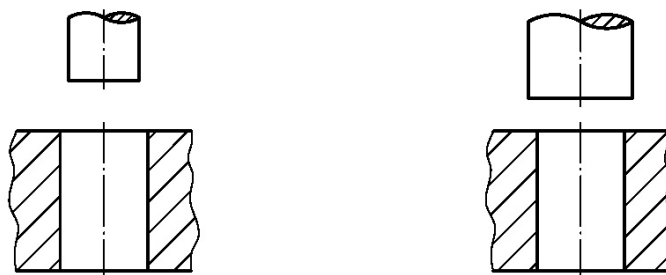
Figura A.2. Ejemplo gráfico de “juego” (a la izquierda) y “apriete” (a la derecha).
